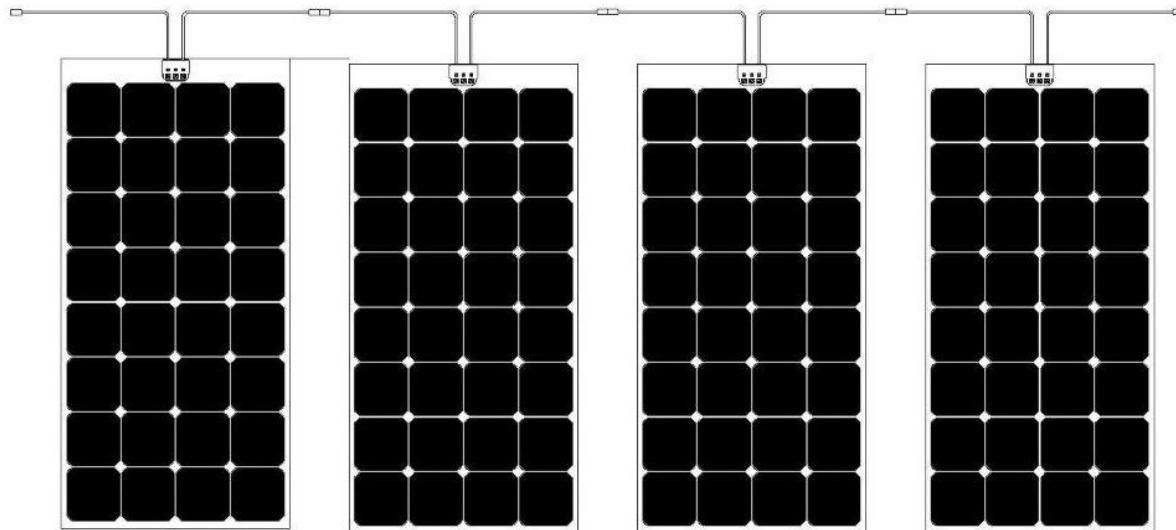
Moduli dello stesso tipo possono essere sempre connessi in serie. La connessione in serie tra moduli di tipo diverso può essere effettuata solo dopo autorizzazione del personale tecnico di Enecom.
