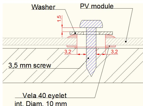
Durante il montaggio, evitare di applicare pressione sulle celle o sovraccaricamento del pannello.
